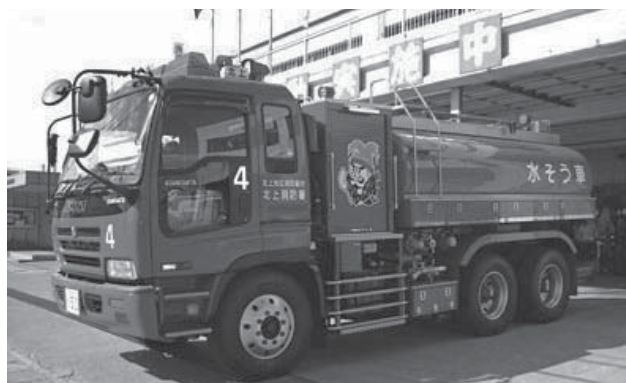
小型動力ポンプ付水槽車 (容量10トン)
