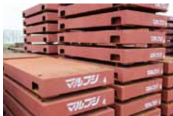
④回収した覆工板。一見まっすぐに見えるが、三村さんは一瞬でゆがんだ場所を見抜いた。⑤整備後の覆工板。
