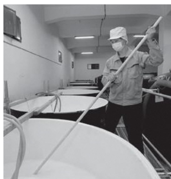
▲発酵タンクをかき混ぜています
