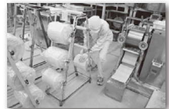
▲麺帯を作り、重ねていく。麺帯1個から120gの麺が約95食分生成される。独自の味を出すため、製粉のブレンドや熟成なども行っている。
