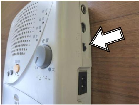
本体右側面の電源スイッチを「切」側にし、正面の「電源」ランプが消えたことを確認します。
