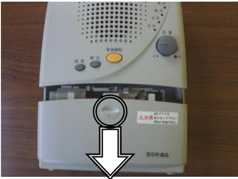
図に示すように電池ブタの○印を指で押しながら、矢印方向に動かすとスライドします。古い乾電池を取り出してください。
