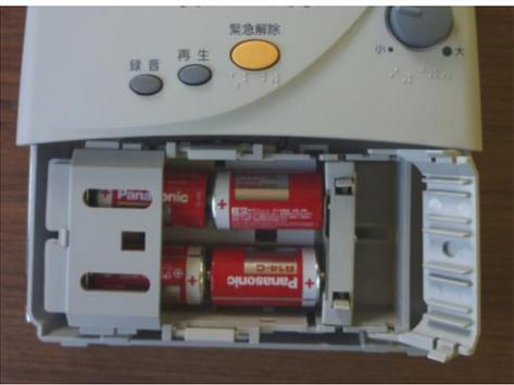
電池収容部に表示されている⊕⊖表示に従って、新しい乾電池を装着します。
