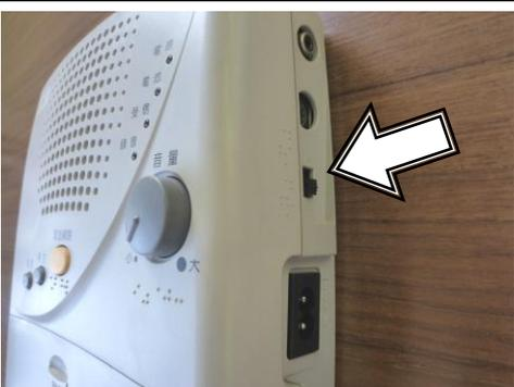
本体右側面の電源スイッチを「入」側にし、正面の「電源」ランプが緑色に点灯していることを確認します。
